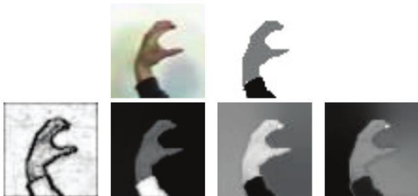
Рис. 9.5. Сегментация изображения с применением алгоритма нормализованного разреза: исходное изображение и результат сегментации с тремя классами (сверху); первые четыре собственных вектора матрицы графа сходства (снизу)
