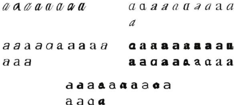
Рис. 6.8. Спектральная кластеризация изображений буквы в разных шрифтах с применением собственных векторов матрицы Лапласа
